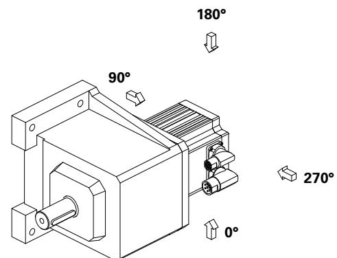
**Beispiel:** Einbaulage EL1 / EL4 mit Steckverbinder in 270°-Position (**Standard**) (Kabeleinführung Seite A)
