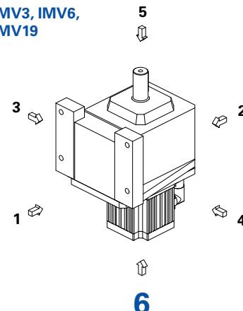
**Die Getriebe** sind mit der auf dem Typschild angegebenen Menge und Art des Schmierstoffs gefüllt. Die Schmierstoff-Füllmenge und der Aufbau der Getriebe sind von der Einbaulage abhängig.
