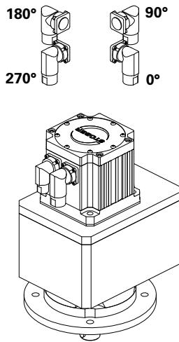
**Beispiel EL5:** Einbaulage - EL5, Steckverbinder in 270°-Position
