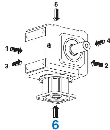
Die Getriebe sind mit der auf dem Typschild angegebenen Menge und Art des Schmierstoffs befüllt. Die Schmierstoff-Füllmenge und der Aufbau der Getriebe sind von der Einbaulage abhängig.
